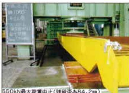
新型桁サポート(荷重450kN時)
